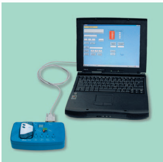
Gebruik van het programma op PC voor de codering van de zenders en de geheugens van de ontvangers
